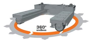
Grazie al moderno sistema sterzante HUBTEX HX, disponibile in optional, è possibile passare dal senso di marcia laterale alla marcia frontale senza doversi fermare. Questo riduce la tempistica del cambio direzione delle ruote e ne riduce l'usura.
