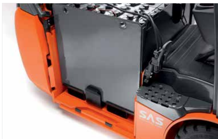
Estrazione laterale della batteria con i vani per forche (illustrati in figura) o la rulliera integrata.
