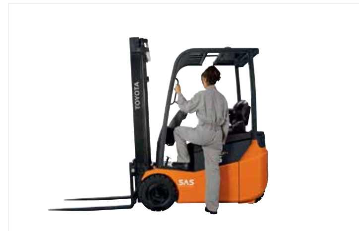
L'altezza ridotta del gradino di accesso facilita l'accesso al carrello di qualsiasi operatore.
