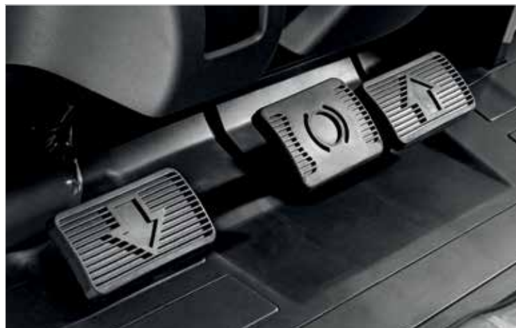
Disposizioni dei pedali diverse per soddisfare le preferenze degli operatori. (in figura è illustrata l'opzione con doppia disposizione dei pedali)
