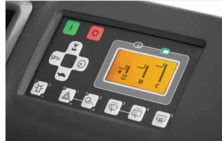
La preimpostazione dell'altezza di sollevamento fa risparmiare tempo e fatica all'operatore.
