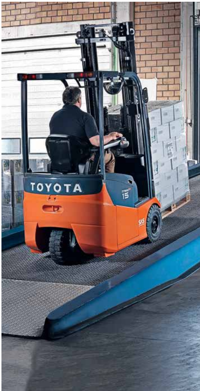
Il montante a grande visibilità fornisce agli operatori un'ottima visibilità del carico e dell'ambiente di lavoro.
