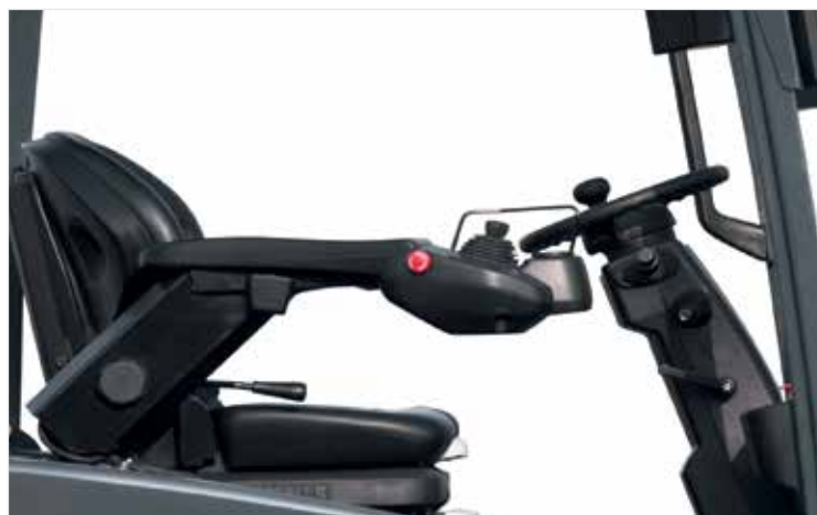
I comandi fingertip nel bracciolo permettono un comando agevole con le punte delle dita delle funzioni di sollevamento, abbassamento, brandeggio e traslazione laterale.
