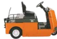
Per alte prestazioni e frequenti operazioni su pendenze, i modelli CBT offrono portate di 4 e 6 t e velocità di marcia fino a 18 km/h.
