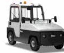
Il modello TE250R è adatto per gli impieghi intensivi fino a 25 t. Con il cofano in posizione anteriore, offre un'eccellente visibilità posteriore.
