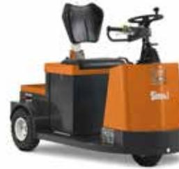
Con il modello compatto TTE30 da 3 tonnellate l'operatore può scegliere di stare seduto sulle lunghe distanze o di stare in piedi per scendere e salire rapidamente.
