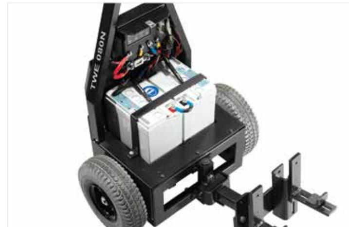
Le batterie al gel non richiedono manutenzione e sono di serie sul modello TWE080N.
