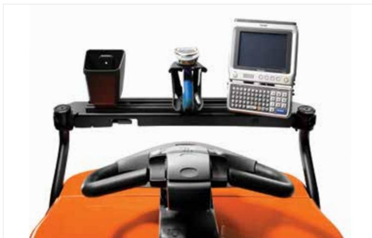
L'E-bar include un punto di alimentazione e permette di collegare facilmente apparecchiature come terminali e scanner per codici a barre.
