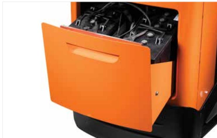
Sostituzione della batteria facile e veloce.
