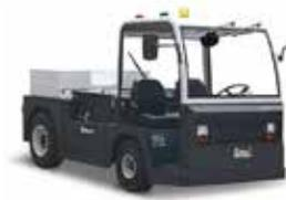
Con una capacità di traino di 50 tonnellate, la gamma TE500RR è progettata per trainare componenti pesanti nell'industria automobilistica, siderurgica e in genere nell'industria pesante.
