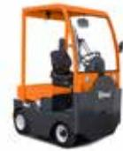
Altamente maneggevole, il TE80 con capacità di traino di 8 t è l'ideale per il lavoro all'aperto sulle lunghe distanze.
