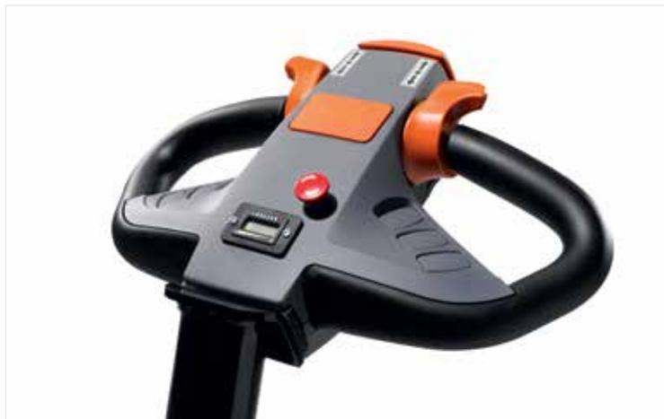
L'impugnatura del timone è ergonomica e facile da manovrare, dotata di un display che indica in modo chiaro e preciso la carica della batteria
