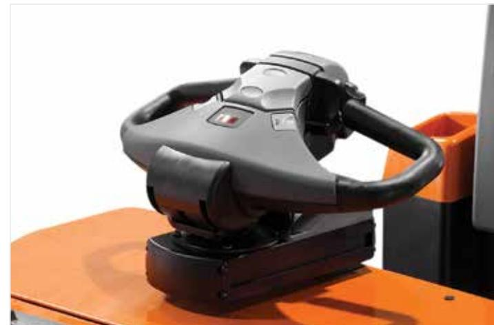
Il sistema di controllo E-man può essere spostato su entrambi i lati del carrello per facilitare le operazioni mentre l'operatore cammina a fianco.
