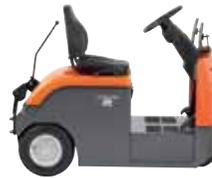
I modelli compatti 4CBT sono dotati di un telaio stretto da 800 mm e sono disponibili con portate di 2, 3 e 4 t.
