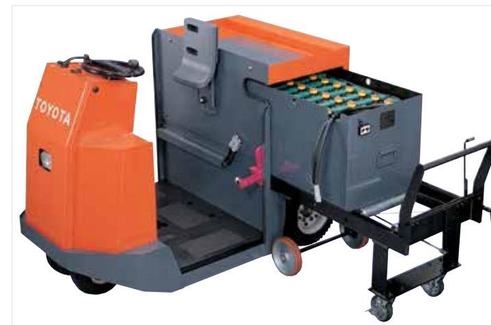
Il vano batteria con rulliera è di serie sul modello CBTY4
