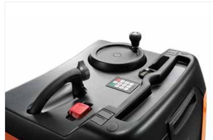
Sterzo con "pomello di rotazione" e accesso con codici PIN.
