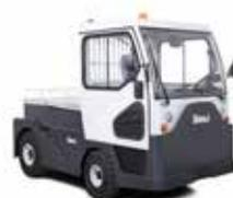
Ideale per il traino intensivo negli aeroporti, il TE291 è dotato di porte scorrevoli, pulsanti di avvicinamento lento e pianale portacarichi posteriore. Ha una capacità di traino di 29 tonnellate.
